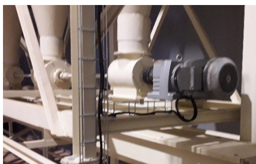
ECLUSAS EM LINHA COM VEIO DE TRANSMISSÃO PARA DESCARGA DE CICLONES
